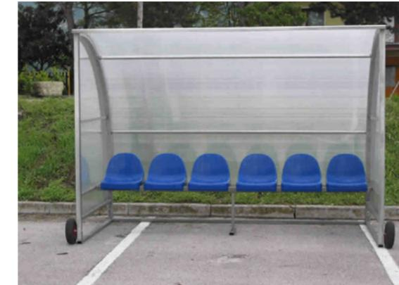
Panchina allenatori/staff-tecnico mobile su ruote, costruita totalmente in alluminio, montanti frontali a sezione maggiorata antinfortunistica 60x70 mm., telaio sezione 50x30 mm. e traversini 30x30 mm.. Copertura in policarbonato compatto trasparente spessore 3 mm.. Completa di ruote gommate adatte anche per il trasporto nell'erba. Modulo da 3 metri con 6 sedute con schienale.
