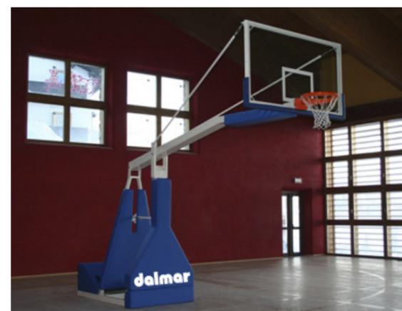
Impianto basket oleodinamico elettrico sbalzo 230 cm, completo con tabelloni in cristallo temperato spessore 12 mm con pellicola di sicurezza, protezioni sottocanestro, canestri reclinabili regolamentari. Omologato TUV secondo Norma UNI EN 1270.
