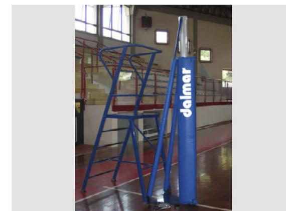
Palchetto per arbitro pallavolo/volley in acciaio verniciato sezione ovoidale 60 x 30 mm., scala di accesso posteriore rivestita in materiale antiscivolo, parapetto di protezione in tubolare diam. 30 mm., piano di calpestio in lamiera verniciata, distanziale di sicurezza, richiudibile con ingombro minimo, misure cm. 50 x 75 altezza cm. 130. Palchetto per giudice di volley certificato dalla Lega Pallavolo Serie A.
