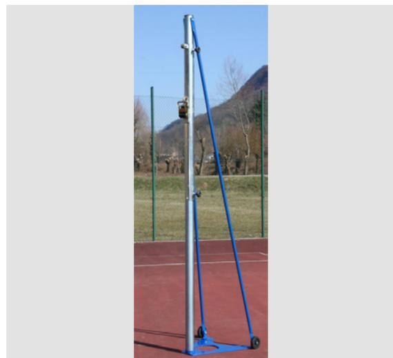
Impianto pallavolo/volley modello Torneo costituito da n. 2 montanti principali in tubolare d'acciaio zincato diam. 70 cm., base a terra a T in piatto d'acciaio verniciato spessore mm. 10, tiranti in acciaio sezione mm 25 verniciati alle polveri epossidiche. Regolazione della rete a mezzo di apposito scorrevole periscopico che permette all'occorrenza di far scendere la rete ad altezza tennis. Tensione della rete a mezzo di argano a cricchetto, viti per il fissaggio a pavimento.
