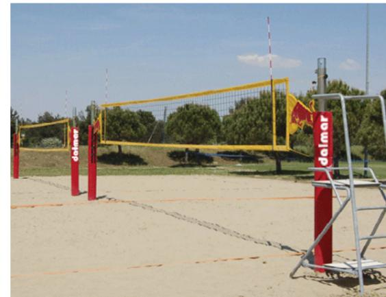
Impianto beach volley monotubolare in acciaio zincato, diametro esterno mm 100, da installare su bussole maggiorate. Completo di sistema scorrevole di regolazione dell'altezza della rete con bloccaggio a volantino. Compreso bussole da cementare, lunghezza cm 100, e tappi copri bussola in acciaio zincato. Completo di dispositivo tendirete integrato in uno dei due pali costituenti l'impianto.
