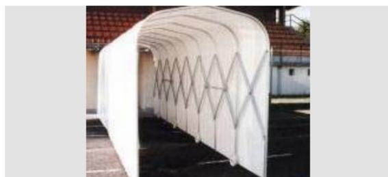
Tunnel per stadio e campi da calcio estensibile e scorrevole su ruote per protezione ingresso giocatori tra spogliatoio e campi da gioco interni ed esterni. Struttura portante in alluminio, cerniere e collegamenti in acciaio verniciato alle polveri poliuretaniche, tessuto spalmato in PVC ignifugo classe M2. Dimensioni: larghezza m. 2, altezza totale m. 2,4. Altre misure a richiesta.
