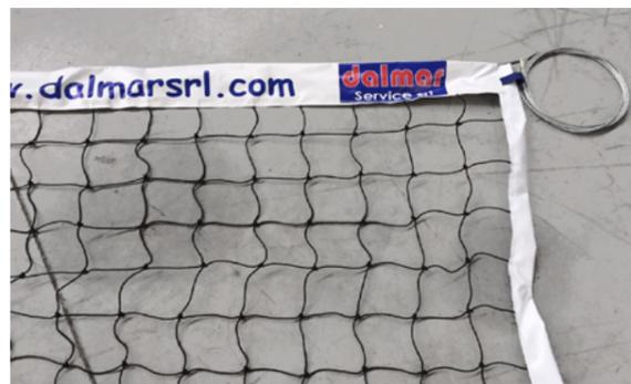
Rete pallavolo modello Mondial Extra, secondo norme FIPAV, in nylon ad alta tenacità, treccia diam. mm. 5. lavorazione senza nodo. Nella parte superiore banda in poliesteri mm. 70, e cavo in acciaio diam. mm. 5. Nella parte inferiore banda in poliesteri mm. 50 e corda in nylon diam. mm. 6. Bande mobili porta antenne, bande laterali per la trazione, complete di aste in fibra di vetro diam. mm. 10. Lunghezza mt. 9,5, altezza mt. 1.
