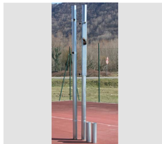
Impianto pallavolo/volley monotubolare costituito da 2 montanti principali in tubolare d'acciaio zincato diam. mm. 100, regolazione della rete a mezzo di scorrevoli periscopici in acciaio zincato diam. mm. 108 e tensione della stessa mediante argano a cricchetto. L'impianto è completo di bussole da interrare per una profondità di cm. 42 con diam. esterno mm. 102 e di appositi tappi copriforo in acciaio zincato.
