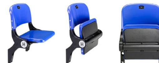
Seduta ribaltabile, dimensionalmente conforme alle raccomandazioni FIFA/UEFA/FIBA. Composta da sedile e schienale in polipropilene, supportati dal nuovo telaio in poliammide: robusto, anti-corrosione, design pulito e minimale, comodo, versatile, (2 versioni disponibili: fronte gradone e con aggancio a trave metallica).
