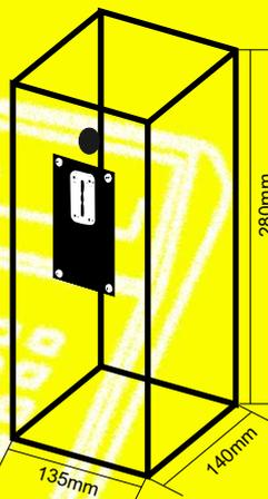
La gettoniera GET12TN è realizzata in Acciaio INOX AISI 316. Questa gettoniera, a differenza dal modello GET12T, è dotata di un alloggio per ospitare le schede temporizzatrici apposite. E' disponibile in tutti i tagli di moneta e gettone ed anche nella versione a Batteria.
