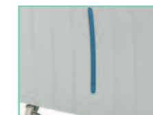
Serbatoio con galleggiante per controllo visivo del livello acqua
